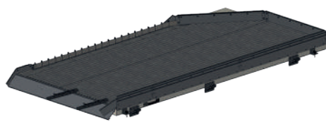
вариант стола "полотно" для зерновых культур
